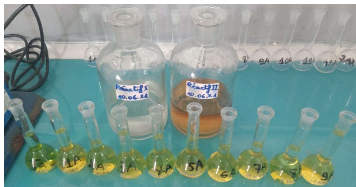
Figure 21 : Photo de dosage d'Ammonium
